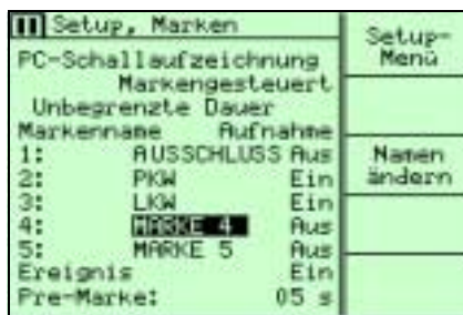
Abb. 4 Einstellung für Schallaufzeichnung in Evaluator Typ 7820
