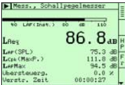
Abb. 8 Multi-D-Display mit simultaner Echtzeitanzeige von Breitbandparametern und verstrichener Zeit
